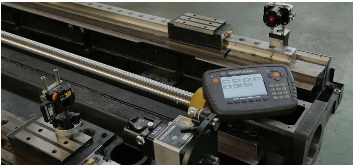
Einsatz des XK10 zur Parallelitätsmessung von zwei Führungsschienen
