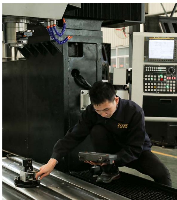
Einsatz des XK10 für Rechtwinkligkeitsmessungen
